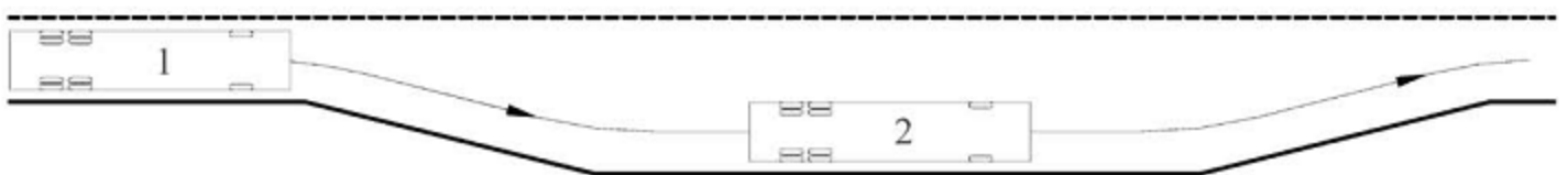
Slika 20. Poligonska radnja - Zaustavljanje vozila na autobuskom stajalištu, radi izlaska i ulaska putnika i polazak sa autobuskog stajališta (deo praktičnog ispita na poligonu kandidata za vozača kategorija D1 i D)
